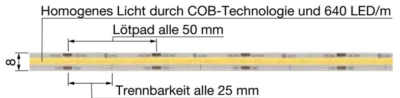
Lineares LED-Band mit Chip on Board COB und **DualColor** Technik.
