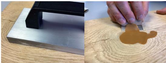
3. Kühleisen entfernen und Rest abschaben
