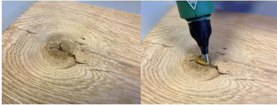
1. Astfüller mit Heißklebepistole aufgetragen
