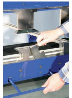
Patentierte Exzenter-Schnellklemmung für Ober- und Biegewange
