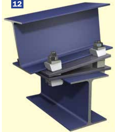
Um 90 Grad versetzte, mittels Distanzstücken geneigte Trägerverbindung
