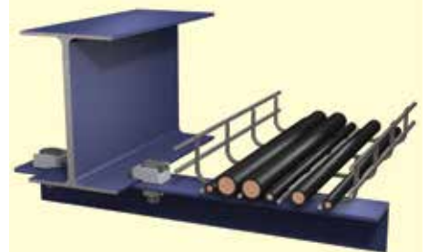
Winkelprofil als Träger für Kabelkanal an Stahlträger
