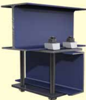
U-Träger um 90° versetzt an Träger
