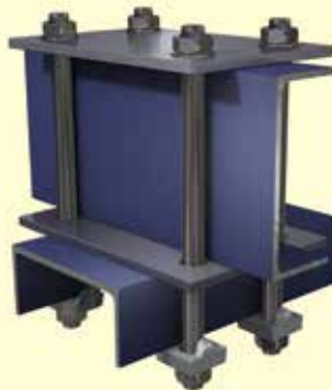
U-Träger um 90° versetzt an U-Träger
