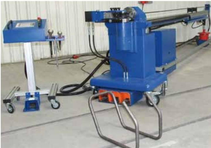
Umbau auf Rechts-Linksbiegen ermöglicht das Biegen symmetrischer Biegeteile
