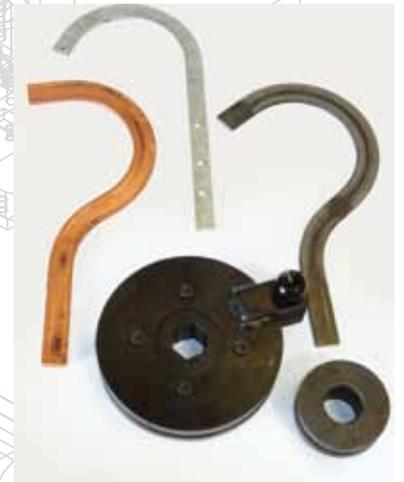
Biegewerkzeug zum Flachstahlbiegen
