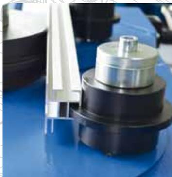
Profilrohr mit Sonderwerkzeug auf RB60
