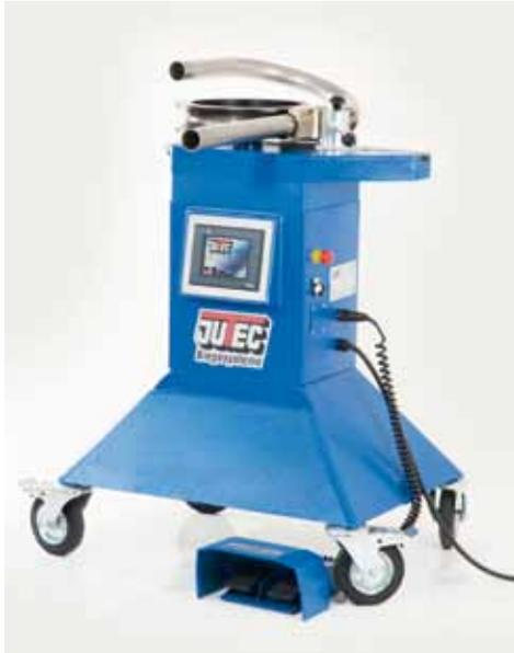
Biegen mit Gleitschuh bei dünnwandigem Rohr
