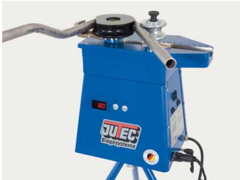
Schneller Werkzeugwechsel durch 6-Kantaufnahme und Schnellverstellung
