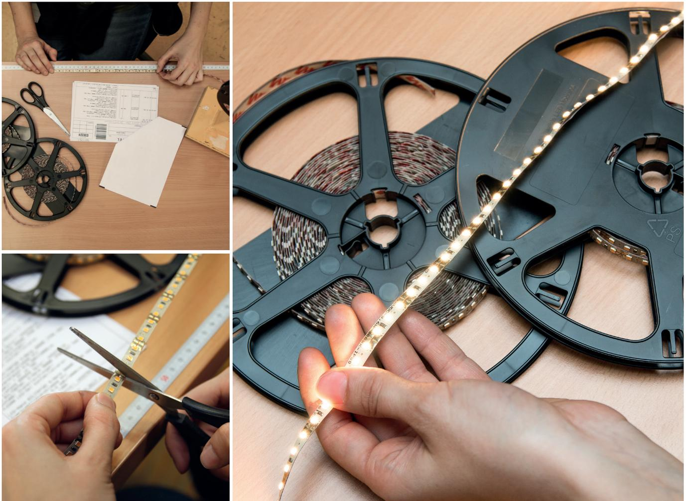
Die Fertigung erfolgt im Längenraster des LED-Bandes
