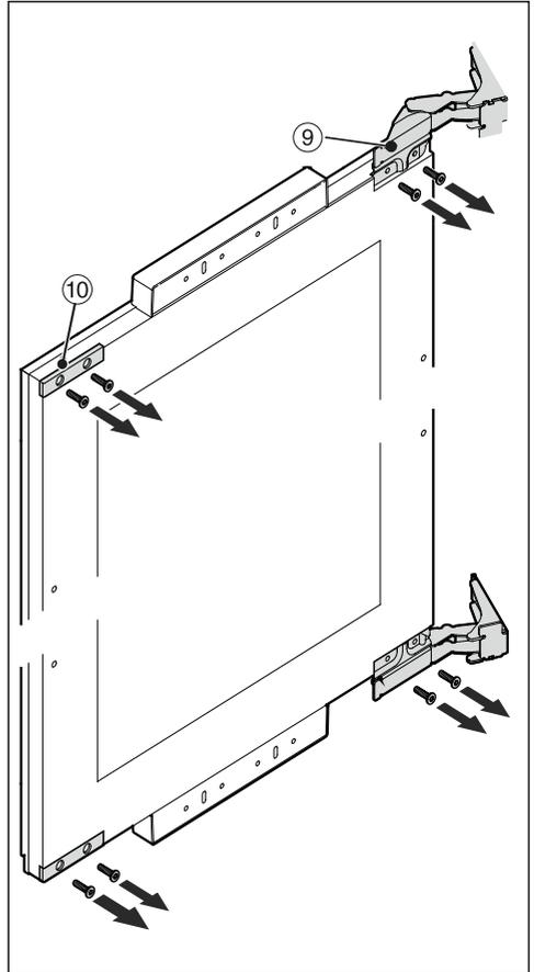
■ Schrauben Sie die Scharniere ⑨ und Abdeckungen ⑩ von der Gerätetür ab.
