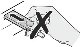
Wird die Schubstange während des Schließvorganges blockiert, so erreicht sie nicht mehr ihre Ausgangsposition.
