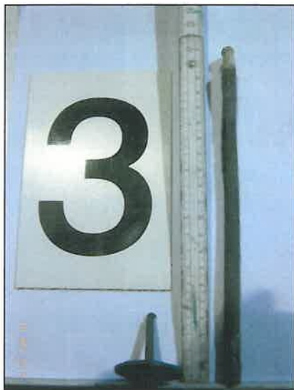
Bild 3: F10M202; Dübel 1.3 Last: 350N ; Versagenszeit: 140min
