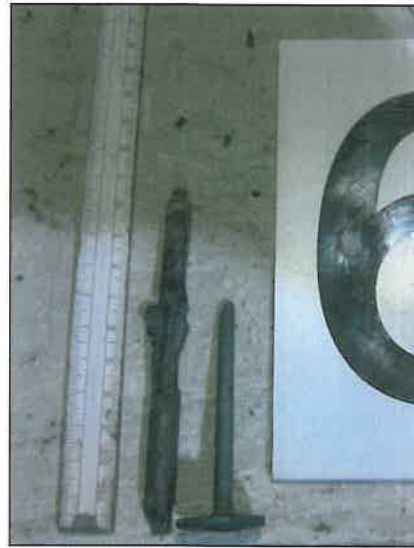
Bild 2: F8M132; Dübel 2.6 Last: 350N ; Versagenszeit:: 82 min
