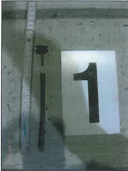
Bild 1: F8M132; Dübel 2.1 Last: 200N ; Versagenszeit:: 163 min
