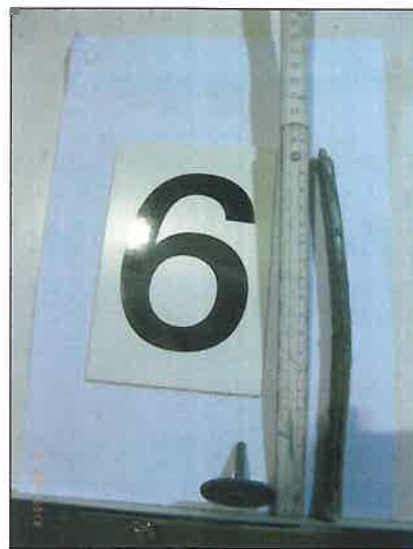
Bild 4: F10M202; Dübel 1.6 Last: 300N ; Versagenszeit: 165 min
