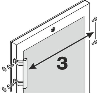
4. Bolzen im Scharnierwinkel umsetzen.
