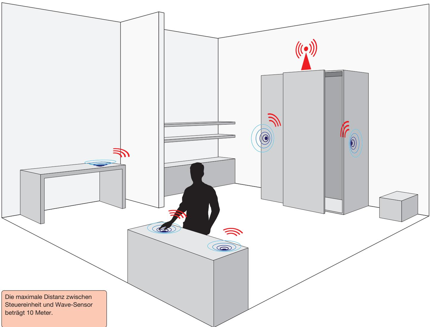
Die maximale Distanz zwischen Steuereinheit und Wave-Sensor beträgt 10 Meter.
