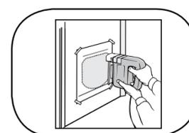
Con una sierra de vaivén o de pelo, corte por la línea de puntos en forma de círculo, tal como se indica en la plantilla.
