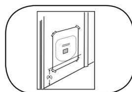
Richten Sie die untere Linie der Vorlage mit der markierten Bauchhöhe an der Tür aus (X).
