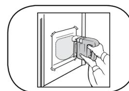
Mit einer Bogen- oder Stichsäge wie angezeigt entlang des Schnittkreises schneiden.
