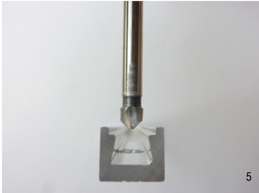
Beim Senken ist besonders darauf zu achten, daß die inneren Seitenflanken der Schiene nicht beschädigt werden. Darum sollte der Senker erst auf das Bohrloch aufgesetzt werden und dann rotieren. Die Senktiefe entspricht der Höhe des Schraubenkopfes.
