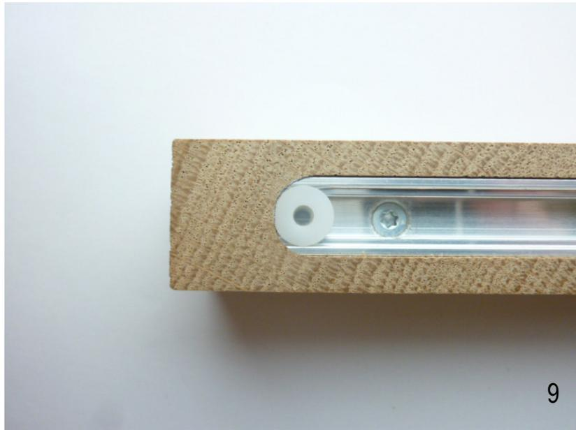
Neben der durchgefrästen Nut und dem Einsetzfräsen stellt Bild 9 eine Variante dar, die häufig mittels CNC-Anlage ausgeführt wird, dabei hat die Aluschiene den gleichen gerundeten Abschluß.
