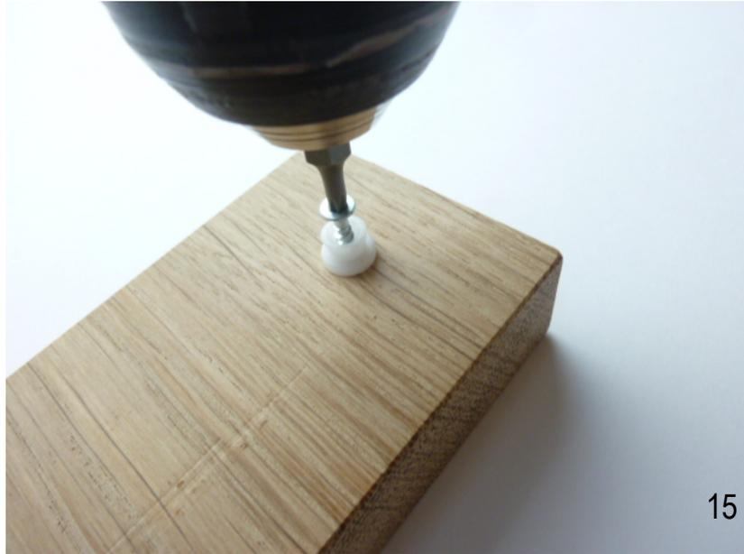
Die Hülsen werden mit 3 mm Senkkopfschrauben auf dem Seitenteil fixiert.
