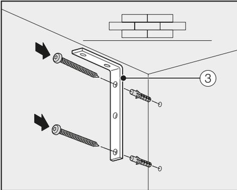
Befestigung an einer Betonwand
