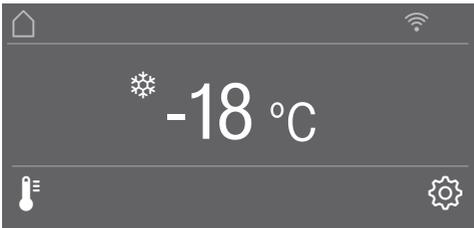
Die Sensortasten, die sich unterhalb der Temperaturanzeige befinden, können über eine Berührung direkt **angewählt** werden, die Symbole und Texte in oder oberhalb der Temperaturanzeige hingegen werden lediglich **angezeigt**.
