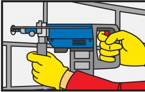
Bohren des Lochs mit einer Bohrmaschine auf den Durchmesser und die erforderliche Tiefe. Den Bohrlochdurchmesser laut Spezifikation der Ankergröße anpassen.
