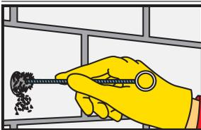
Das Bohrloch muss mit einer speziellen Stahlbürste (mind. 2 mal) gründlich gereinigt werden. Der Durchmesser der Bürste muss größer sein als der Durchmesser der Bohrung (siehe Spezifikation).
