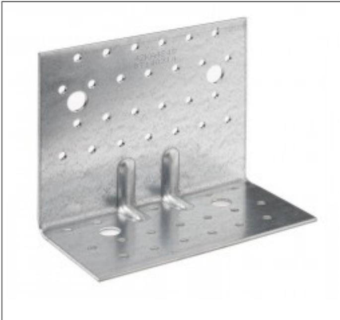
Dieser Winkelverbinder ist für den Anschluss von Holzbauteilen an Holz oder Beton konzipiert. Er kann sowohl Zug- als auch Schublasten aufnehmen. Bei Verwendung unterschiedlicher Ausnagelungen können Balken oder Stützen angeschlossen werden. Ebenso können Brettsperrholzelemente angeschlossen werden, die Faserrichtung der Decklage ist hierbei zur Bestimmung der Verbindungsmittelabstände maßgebend.
