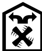
L'air aspiré se nettoie en traversant les filtres à graisse et un filtre au charbon actif, puis il revient dans la cuisine.
