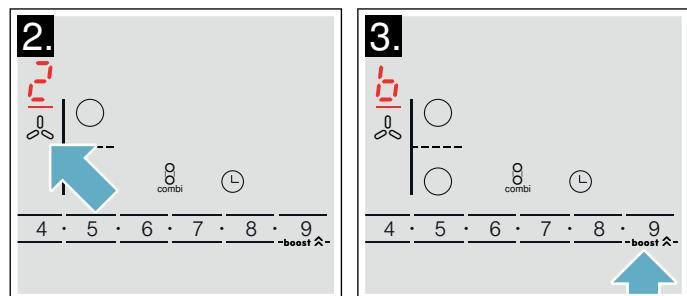
**Remarque :** Au bout de 8 minutes, l'appareil revient automatiquement à la vitesse de ventilation .
