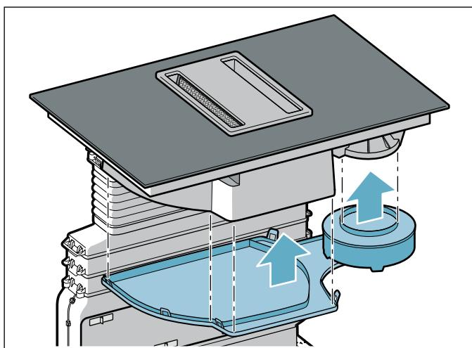
2. Videz le réservoir de trop-plein et le cas échéant, le capot de l'appareil, puis nettoyez-les.
