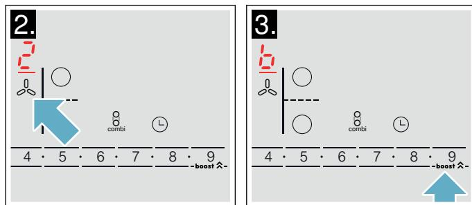
**Hinweis:** Nach 8 Minuten schaltet das Gerät selbstständig auf die Leistungsstufe **9** zurück.
