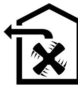
L'air aspiré est débarrassé des particules de graisse par les filtres à cet effet, transite par un conduit puis gagne l'extérieur.
