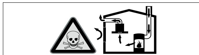
Les foyers à air ambiant (par exemple les chauffages à gaz, à bois, à fioul ou à charbon, les chauffe-eau instantanés, les ballons d'eau chaude) prélèvent l'air de combustion dans la pièce où ils sont installés et rejettent les gaz de fumée à l'air libre par un système spécifique (par exemple cheminée).
