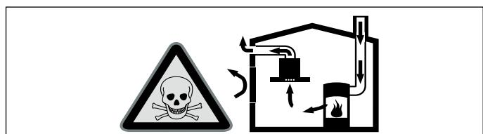
Raumluftabhängige Feuerstätten (z.B. gas-, öl-, holz- oder kohlebetriebene Heizgeräte, Durchlauferhitzer, Warmwasserbereiter) beziehen Verbrennungsluft aus dem Aufstellraum und führen die Abgase durch eine Abgasanlage (z.B. Kamin) ins Freie. In Verbindung mit einer eingeschalteten Lüftung wird der Küche und den benachbarten Räumen Raumluft entzogen - ohne ausreichende Zuluft entsteht ein Unterdruck. Giftige Gase aus dem Kamin oder Abzugsschacht werden in die Wohnräume zurückgesaugt.
