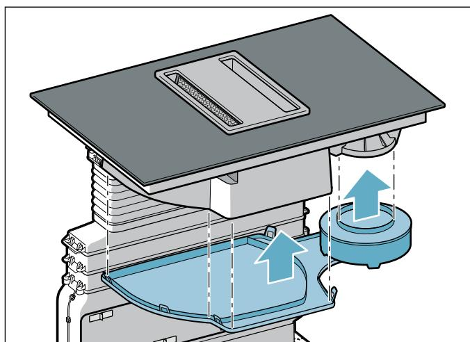
2. Svuotare e lavare il serbatoio di raccolta ed eventualmente la copertura dell'alloggiamento.
