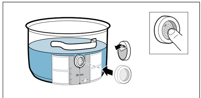
3. Die gesamte Oberfläche des Silikonpatches andrücken, auch den inneren Bereich. Der Klebstoff benötigt zur korrekten Aushärtung 1 Stunde. Den Topf während dieser Zeit nicht benutzen oder reinigen.
