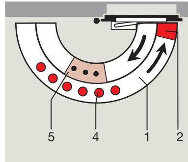
Die Schließgeschwindigkeit des TS 92 ist über Ventile in zwei voneinander unabhängigen Bereichen stufenlos einstellbar. Die Schließkräfteeinstellung für die jeweilige Türbreite erfolgt beim TS 92 stufenlos über die seitliche Stellschraube.
