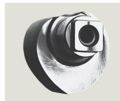
Die herzförmige Nockenscheibe und der Lineartrieb, die alle Gleitschienen-Türschließer auszeichnen, sorgen für eine leichte Betätigung der Tür durch stark abfallendes Öffnungsmoment. So haben selbst Kinder, alte Menschen und Behinderte keine Mühe mehr, Türen zu öffnen. Benutzerfreundliches und zugleich zuverlässiges Schließen durch erst in der Endphase ansteigendes Schließmoment.
