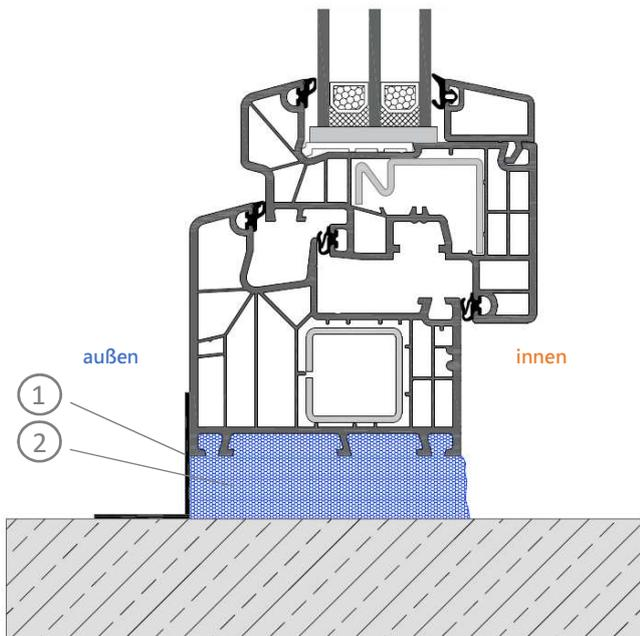
SWS Outside Extra ist eine flexible, vollflächig selbstklebende Folie zur dampfopenen, luft- und schlagregendichten Abdichtung von Verbindungen an Fenstern und Türen. Auf der bedruckten Seite der Folie befindet sich ein Selbstklebeband zur einfachen und effizienten Montage auf dem Fensterprofil. Die Rückseite der Folie besteht aus einer starken, vollflächigen selbsthaftenden Schicht zur Befestigung am Bauwerk. Die Folie kann sofort verputzt und überklebt werden.
