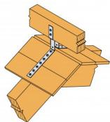
Die TOL40 Firstlattenhalter sind für Dachlattenbreiten ca. 40 mm und die TOL50 Dachlattenverbinder für Dachlattenbreiten ca. 50 mm geeignet.
