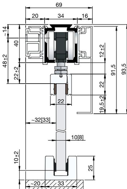
mit Klemmbefestigung, Adapterprofil 5
