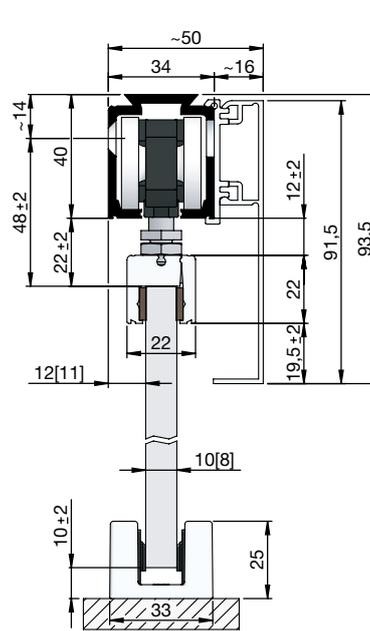
mit Klemmbefestigung, Adapterprofil
