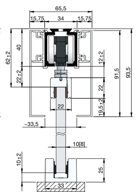
mit Klemmbefestigung, Adapterprofil
