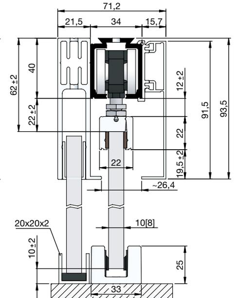
mit Klemmbefestigung, Seitenteilprofil mit
