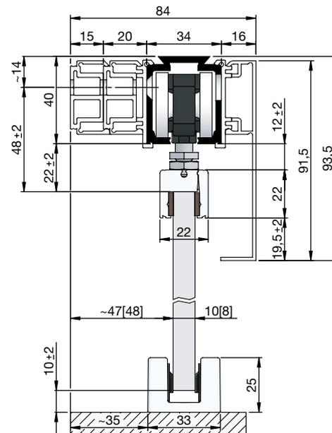
mit Klemmbefestigung, Adapterprofil 5 mm,
