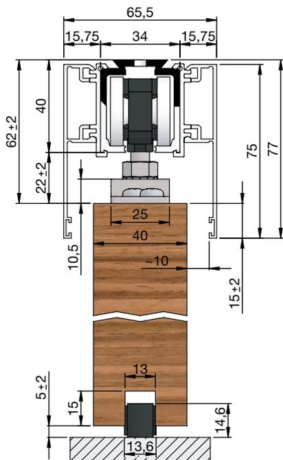
mit Tragflansch, Adapterprofil 5 mm,
