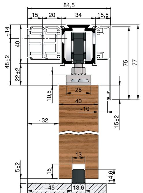
mit Tragflansch, Adapterprofil 5 mm,
