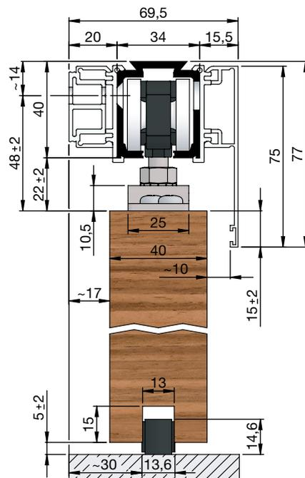
mit Tragflansch, Adapterprofil 5 mm,
