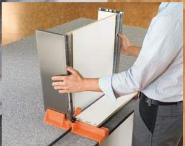
BOXFIX E-L unterstützt Sie optimal: Ohne umständliches Halten können die Schubkastenteile präzise und spaltfrei montiert werden.
