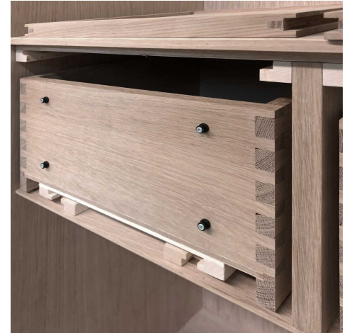
Keilhülsen zum Aufschieben des Doppels
