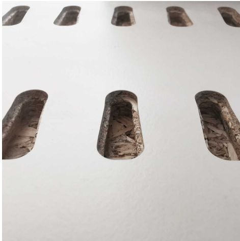
Keiltasche zur Befestigung für Schubladendoppel
