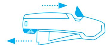
Schieben Sie die Sicherung in die hintere Position, damit sich der **Hebel wieder lösen** kann. **Danach** Klingelwechselknopf in den Griff zurückdrücken und weiterschneiden.
