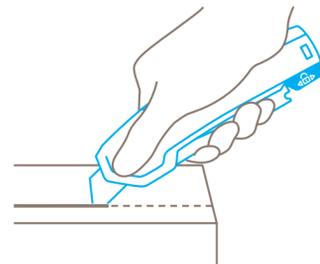
Um die **Klinge auszulösen**, Sicherung **in die hintere Position** ziehen und Hebel betätigen. Jetzt können Sie schneiden.
