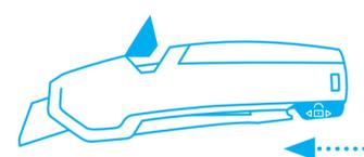
Fixieren Sie den Hebel mit der Sicherung und drehen Sie den Griff so, dass die **transparente Klingelabdeckung nach oben** zeigt.
