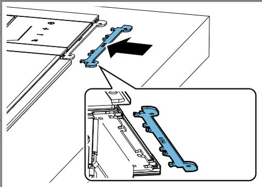
Das Gerät zum Einstecken der Design-Profilhalterung ca. 5 mm anheben.
