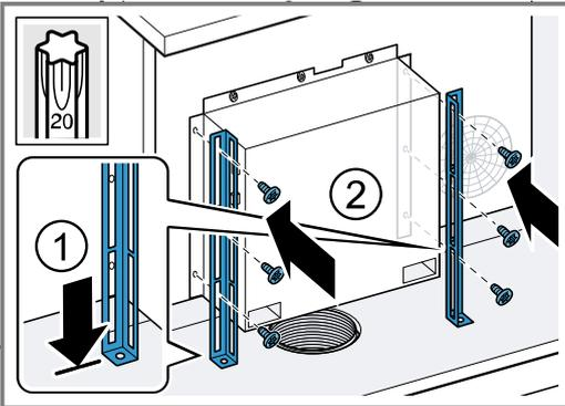
**11.** Am Schrankboden die Schienen festschrauben.
