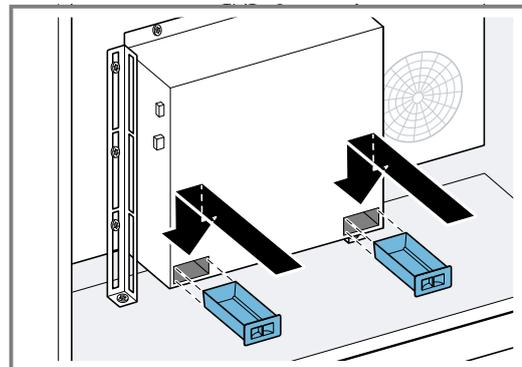
15. Die Kabel am Lüfterkasten einstecken.
