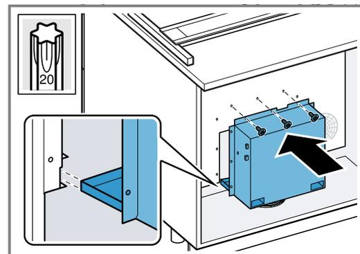
7. Das Gerät von unten stützen und die Leisten entfernen.
