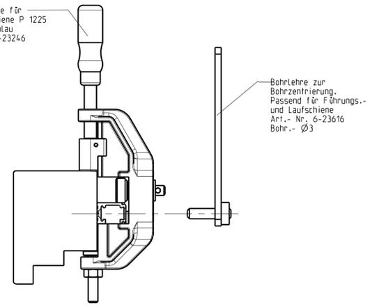
Bohrlehre für Getriebedrehgriff
