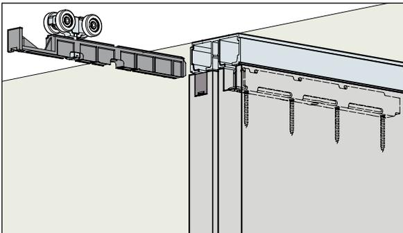
System: Laufschiene obenlaufend, minimale Einbauhöhe, Deckenmontage, für Holztüren bis 100 kg
