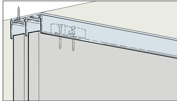
System: Laufschiene untenlaufend, für Holztüren bis 80 kg
