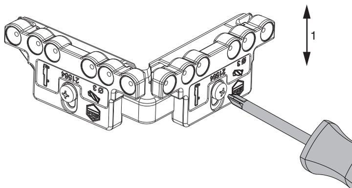
Bohrlehre auf das Aufdeckmaß X (Anpressdruck der Dichtung - siehe unten) einstellen (1)
