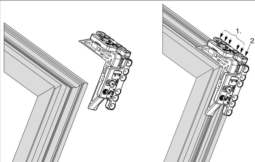
1. Mit Bohrer  $\varnothing$  3mm vorbohren.
