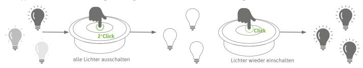
Alle Lichter werden ausgeschalten. Diese Funktion wird zum Synchronisieren mehrerer Lichter verwendet wenn diese asynchron laufen.
