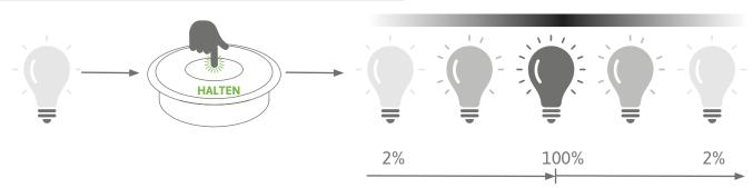
Ein längerer Druck auf den Schalter kann dazu verwendet werden, die Helligkeit stufenlos zu erhöhen oder zu verringern. Dies ermöglicht eine präzise Einstellung der Beleuchtung nach individuellen Vorlieben. Standardmäßig startet das Licht bei 50 % Helligkeit. Durch das Betätigen der Dimmfunktion (anhaltendes Drücken) startet das Licht mit dem zyklischen Dimmen.
