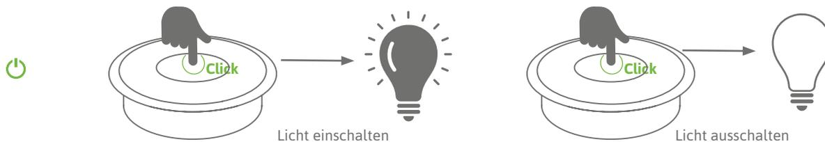
Bei SIRO Lichtschaltern wird ein Einfachklick dazu verwendet, die angeschlossene Lichtquelle ein- oder auszuschalten.
