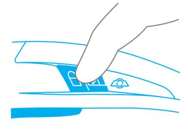
Drücken Sie nach dem Schneiden die **Sicherung**, damit die Klinge nicht unbeabsichtigt herausfahren kann.
