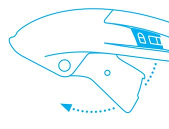
Danach drehen Sie den **Hebel aus dem Griff** heraus und öffnen Sie die Klingensicherung.
