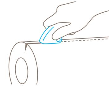
Um **ergonomisch zu arbeiten**, nutzen Sie den vorderen Griffbereich am besten komplett als Auflagefläche.
