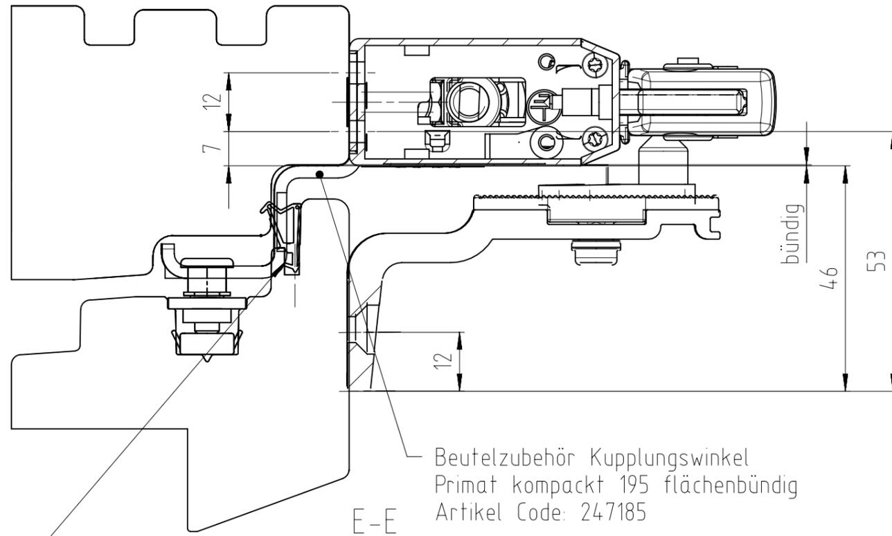
120mm im Bereich der Kupplungswinkel frei schneiden.
