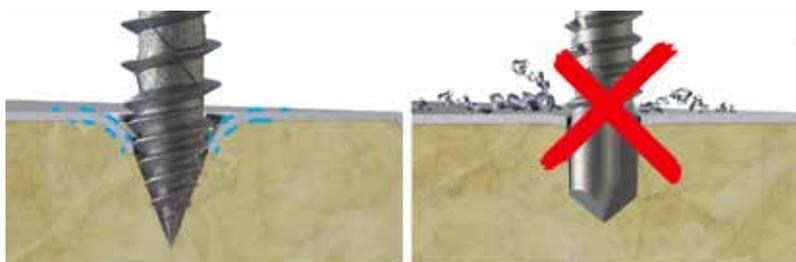
Spanfreie Befestigungslösung von REISSER (links) bei der das Material (Profilblech) aufgebrochen und nach unten verdrängt statt entfernt wird.
