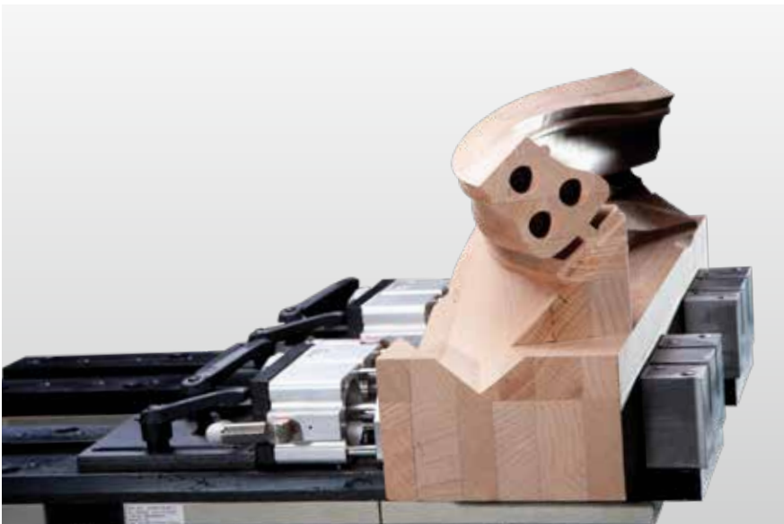
Klemmvorrichtung sorgt für sicheres und schnelles Spannen von Pfosten und Kanteln.
