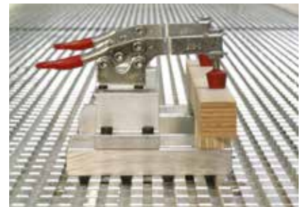
Befestigung von Sonderspannmitteln Der Aluminiumrastertisch mit Schwalbenschwanzführungen gewährleistet die präzise formschlüssige Spannelementfixierung
