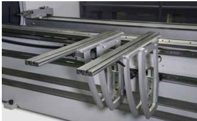
Auflagearme auf Führungsschienen vorne ermöglichen eine schnelle Positionierung über die gesamte Biegelänge
