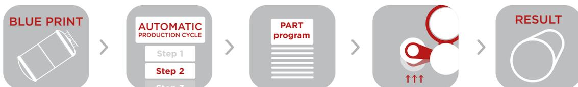
Wählen Sie einfach die Form des Werkstücks am Bildschirm aus und geben Sie Materialtyp, Blechbreite, Blechstärke und gewünschten Innendurchmesser ein. Die CNC Steuerung ermittelt alle notwendigen Achsenbewegungen und Positionen der Achsen und erstellt ein komplettes Walzprogramm, das sofort für den Testlauf bereit ist und vom Bediener angepasst werden kann.
