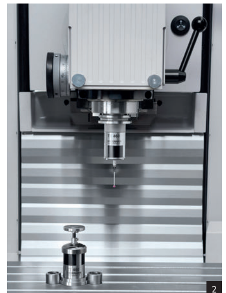
CNC-Teilapparat (1), Tastkopfsystem und automatische Werkzeugvermessung (2)
