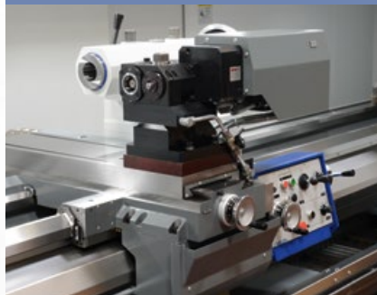
Werkzeugträgerkopf zum Drehen, Bohren und Fräsen
