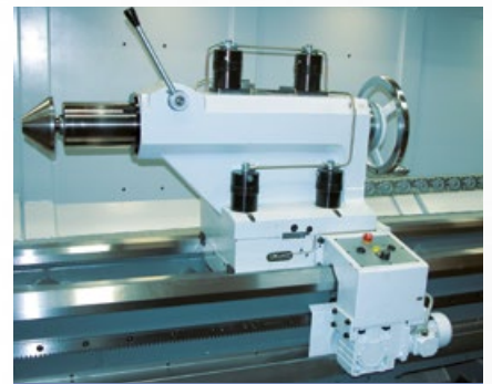
Reitstock mit automatischer Klemmung und eigenem Antrieb
