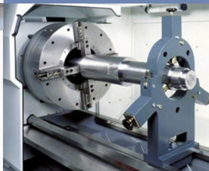
Pneumatisch betätigtes Vorderendfutter und feststehende Lünette
