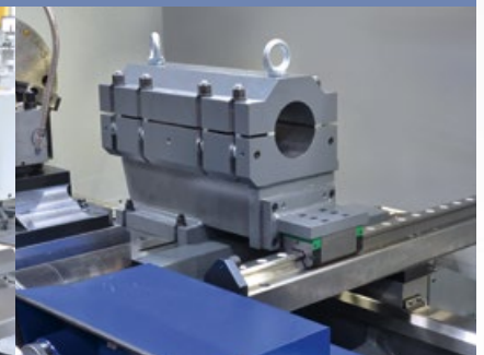
Bohrbock mit zusätzlicher Abstützung
