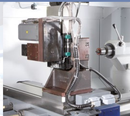
Y-Achse mit 200 mm Hub
