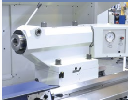
Reitstockpinole hydraulisch betätigt
