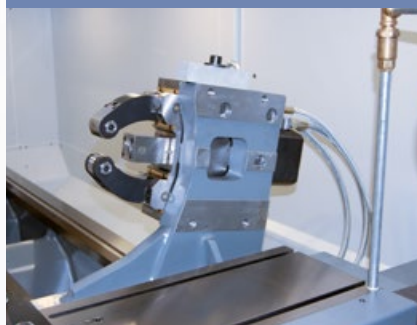
Mitlaufende, selbstzentrierende Lünette, hydraulisch betätigt
