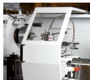
Verfahrbare, umfassende Spänespritzschutzhaube mit Sichtfenster
