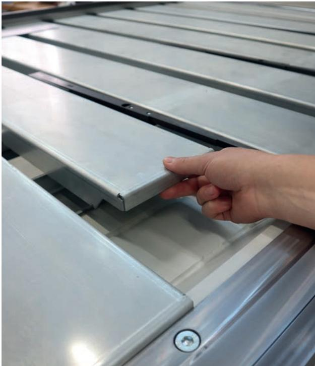
Standard: Herausnehmbare Auflagebleche, rückziehbar auf 337 mm.
