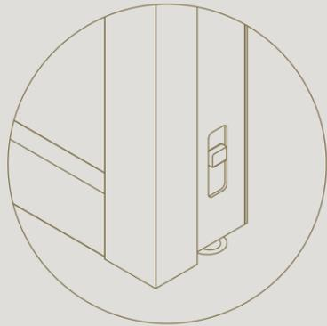
Diskrete Standflügelverriegelung zum gleichzeitigen Lösen des oberen und unteren Riegels der Passivtür
