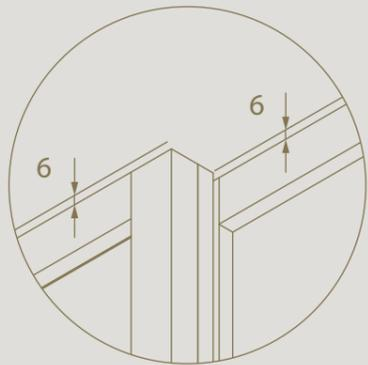
Eine eingelassene Laufschiene sorgt für eine identische Höhenausrichtung aller Profile
