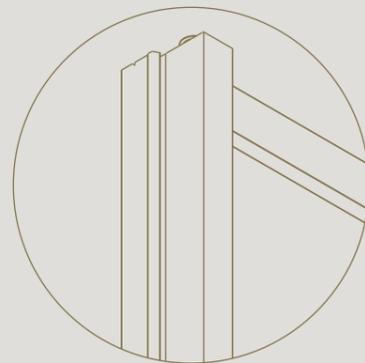
Ausgestattet mit einem Anschlagprofil zwischen beiden Türen
