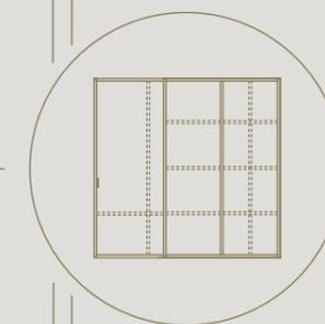
Optional mit frei positionierbaren Sprossenprofilen
