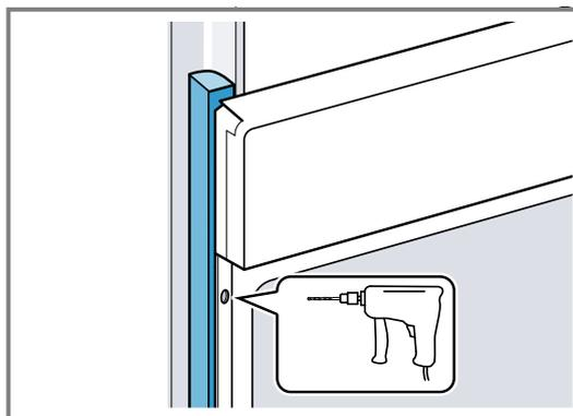
4. Das Gerät mit adäquater Schraube befestigen.
