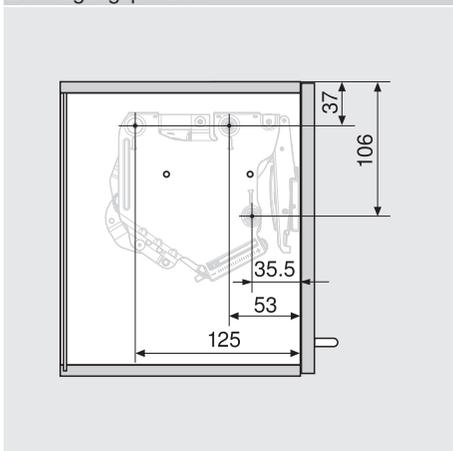
3 x Spanplattenschrauben Ø 4 x 35 mm
