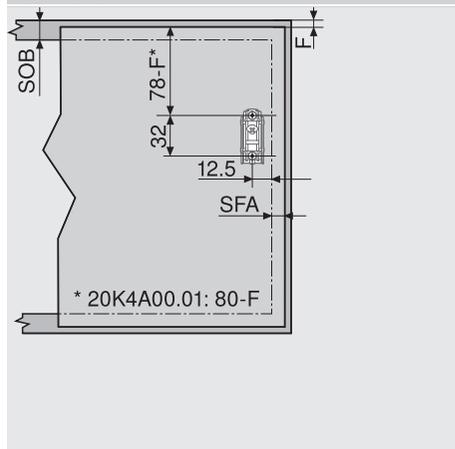
Für Holzfronten 2 Spanplattenschrauben (104404791/793) verwenden. Für breite Alurahmen 2 Senkkopf-Blechschraben (104412608) verwenden
