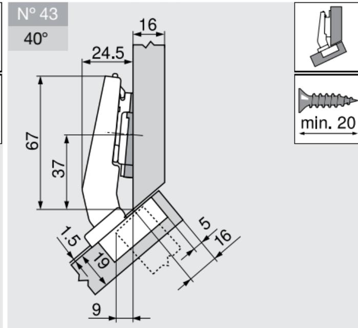
Der Winkelkeil wird um 180° gedreht eingebaut (Pfeil zeigt zum Korpus)!
