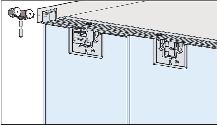
System: Laufschiene eingenetet oder aufgeschraubt, keine Nut im Boden, ohne Blende, Laufwerk geklebt, für 2 Glastüren bis 16 kg. Design Inslide
