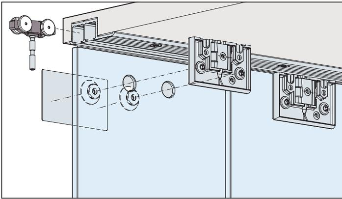
System: Laufschiene eingenietet oder aufgeschraubt, keine Nut im Boden, ohne Blende, Laufwerk geschraubt, für 2 Glastüren bis 16 kg.
