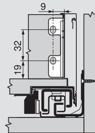
Schraubposition der Korpuschienen – 40 kg
